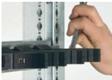
Rögzítjük a síntartót az M6-os csavarok segítségével (a meghúzási nyomaték 7 Nm)
