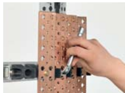
Rögzítjük a rézsíneket a síntartón (a meghúzási nyomaték 7 Nm)
