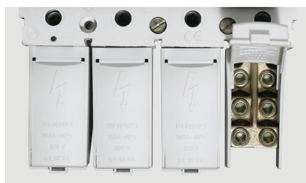
6 x 35 mm 2 merev (vagy 25 mm 2 hajlékony) kimeneti ágak a 0 048 67 kat. számú elosztókapcsan.
